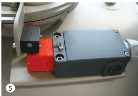
Противоаварийной электрический замок
